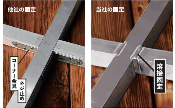
金属加工の技術を活かし、BOXの骨組みであるフレームを丁寧に溶接して組み立てているので、ネジ止めと比べて強度が高く安心。振動への耐久性に優れています。
