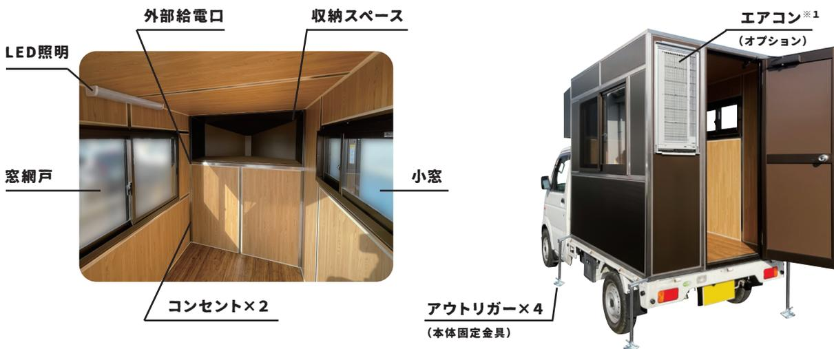
※1：標準装備は換気扇です。写真は換気扇の代わりにエアコンを搭載しています。(エアコンはオプションにて対応可能)
