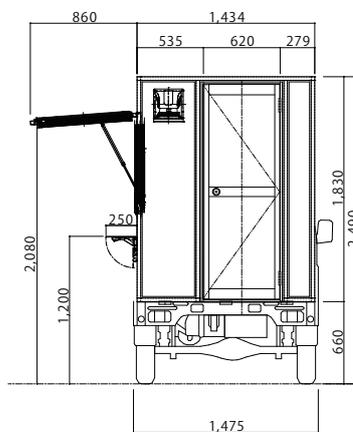
【標準仕様】 フレーム：アルミフレーム 外壁：シルバー（写真はブラウンに塗装） 重量：250kg
